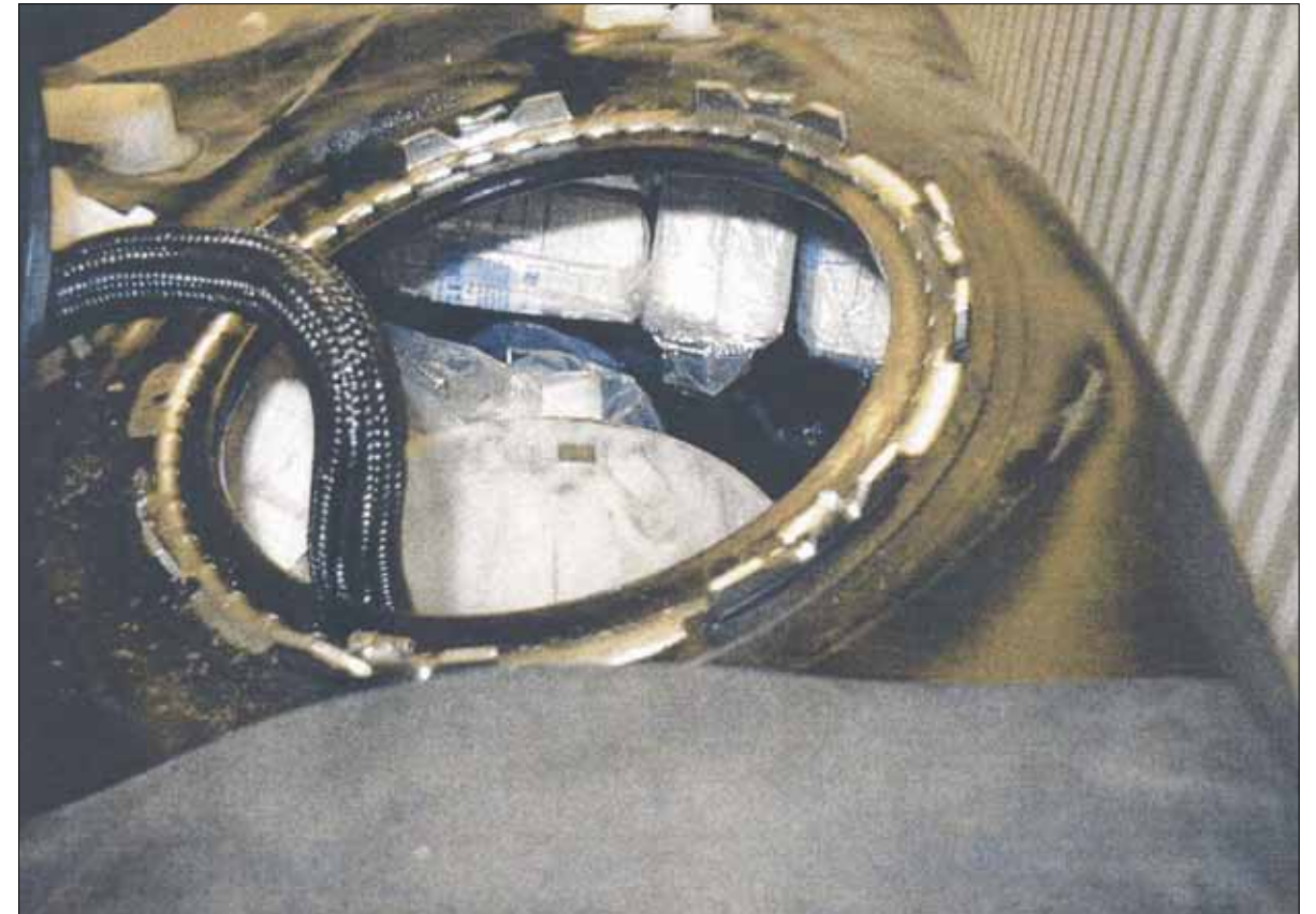
Sedan bränslegivaren demonterats blev det fri sikt till bränsletankens inre och där framträdde något som inte normalt hör hemma i en bränsletank: inplastade paket...
